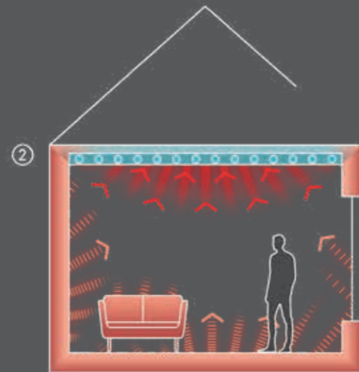
2 Die abgekühlte Deckenoberfläche absorbiert Wärmestrahlung aus dem Raum. Diese Wärme führt sie permanent mit ihrem Kühlwasser ab. Der Strahlungsaustausch zwischen der kühlen Decke und den warmen Oberflächen kühlt jetzt auch die Wände, den Boden und die Möbel.
