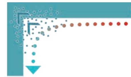
Ist die Luft wärmer als die Hüllflächen, kühlt sie sich daran ab, die rel. Luftfeuchte steigt und die Feuchtigkeit wird vom Mauerwerk aufgenommen.
