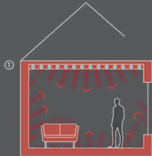
1 Sind die Oberflächen im Sommer aufgeheizt, strahlen sie viel Wärme in den Raum. Durch die Rohre der Klimadecke wird nun kaltes Wasser geleitet, um die Deckenoberfläche zu kühlen.
