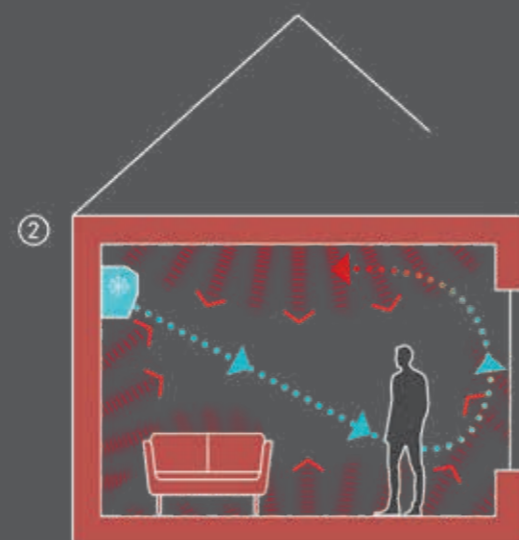
2 Da die warmen Hüllflächen die Wärmeregulation über den Strahlungsaustausch verhindern, schwitzt der Mensch, um sich durch Verdunstung zu kühlen. Der kalte Luftzug einer Klimaanlage verdunstet den Schweiß und kühlt die Haut.
